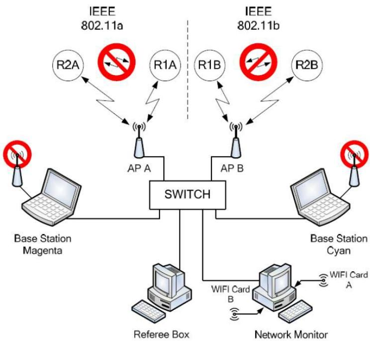
如果在比赛的时候，有稳定的网络监控程序可以使用，每个场地会设置一台指定的计算机用于网络监控。这台计算机必须安装有两块独立的，分别支持802.11a和802.11b的无线网卡。这两块无线网卡只侦听无线网络通讯，不会影响正常的无线网络通讯。网络监控程序将仅用于确认各参赛队的网络通讯满足上述要求。中型组技术委员会和组织委员会将会尽力保证在比赛的时候有这样的网络监控程序可用，但目前还没有这样的程序可供使用。
